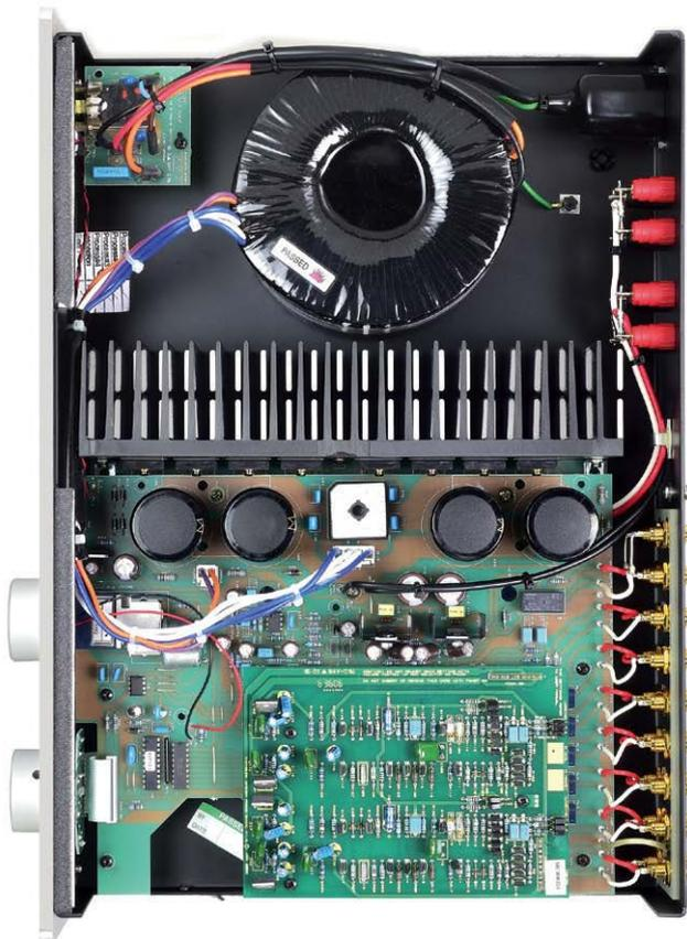
Die optionale Phonostufe (rechts unten) sitzt huckepack auf der Verstärkerplatine und weist diverse Jumper auf, die zur Verstärkungs- und Impedanz-einstellung dienen.
