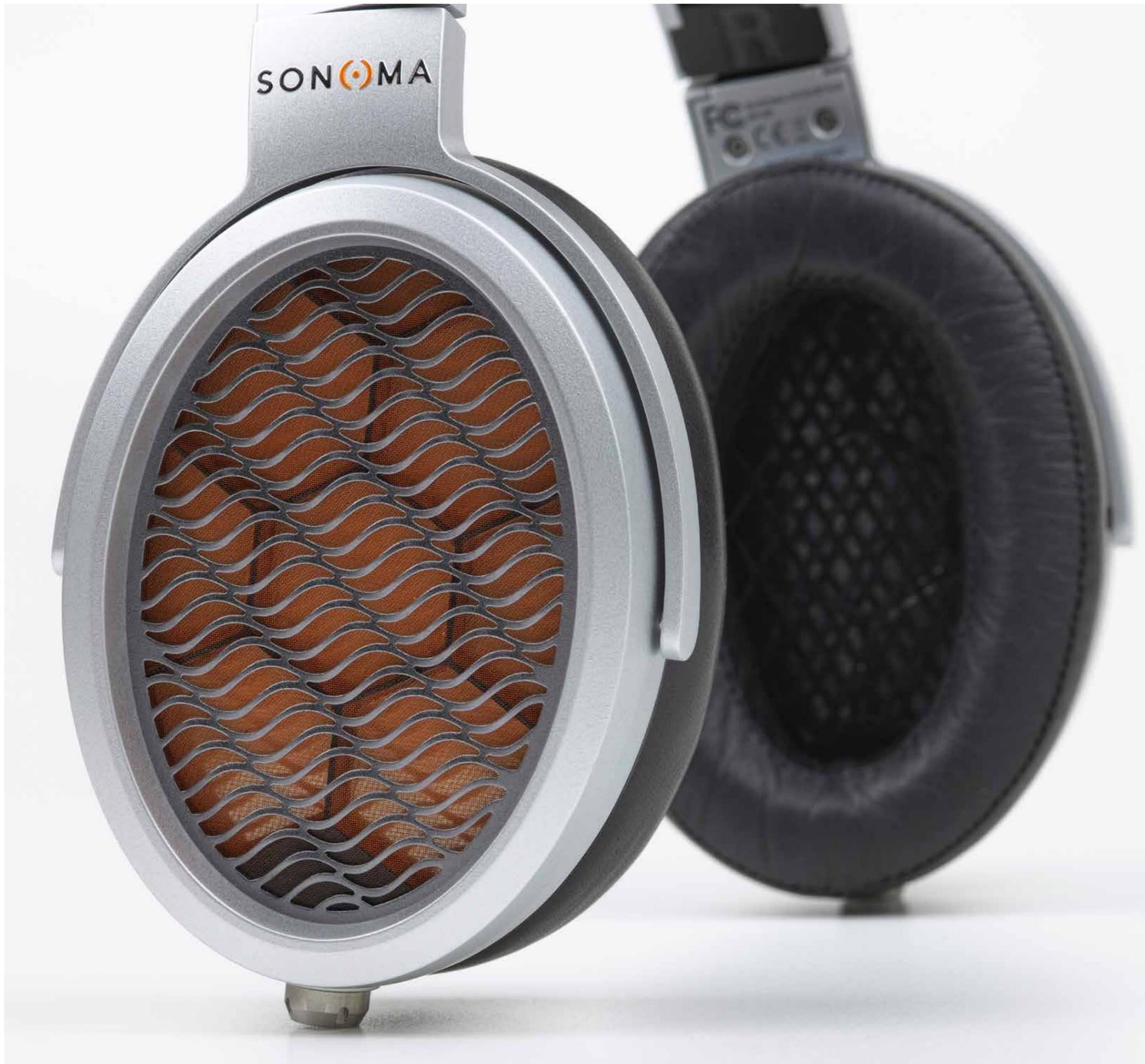
Gut hinter dem Schutzgitter zu erkennen: die in wabenförmige Zellen aufgeteilte Membran. Der Sonoma ist ein Elektrostat mit neuartigen, einzigartigen sogenannten HPEL-Schallwandlern, die mit nur einem Stator auskommen.
