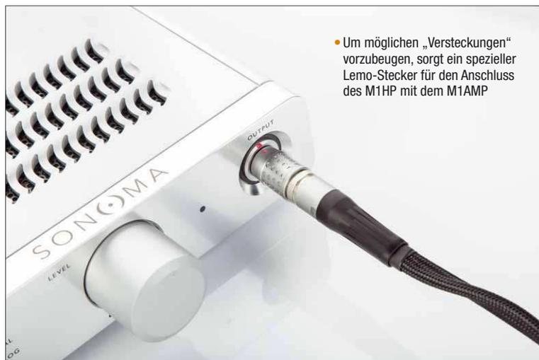
• Um möglichen „Versteckungen“ vorzubeugen, sorgt ein spezieller Lemo-Stecker für den Anschluss des M1HP mit dem M1AMP
