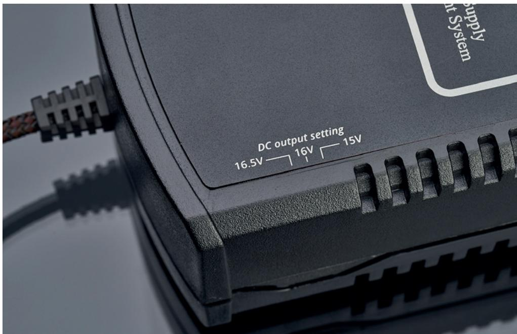
Das Ultra MKII ist ein Filter, das die Spannung vermindert. Um dem angeschlossenen Verbraucher 15 Volt zu liefern, sollte das Netzteil auf 16 Volt eingestellt werden, um den Spannungsabfall durch das Ultra zu kompensieren
