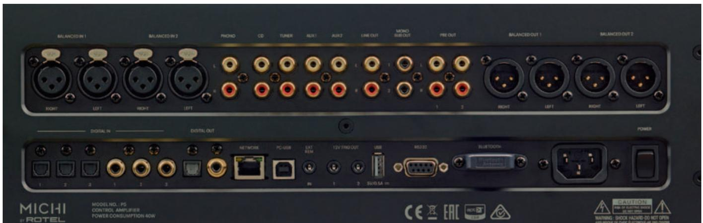
Gute Idee: Der USB-A-Anschluss (Mitte, rechts neben den Triggerbuchsen) ist kein Audioport, sondern ein Ladeanschluss und damit beispielsweise die Energieversorgung für ein Streaming Device. Die USB-B-Buchse links davon stellt die übliche Computerschnittstelle dar.
