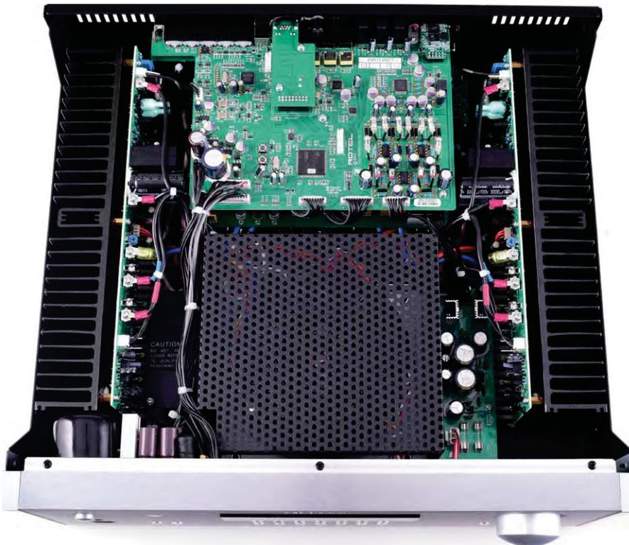
**ELEGANT:** Unter dem gelochten Gittern vorn verbirgt sich ein großformatiger Trafo. Die Leistungsplatinen setzt Rotel an die Seiten und verbindet sie mit Kühlrippen, welche die kompletten Seiten einnehmen. Schön zu sehen: das raumgreifende Digital-Wandler-Board. Die Schaltung folgt den Spielregeln von Class-A/B.
