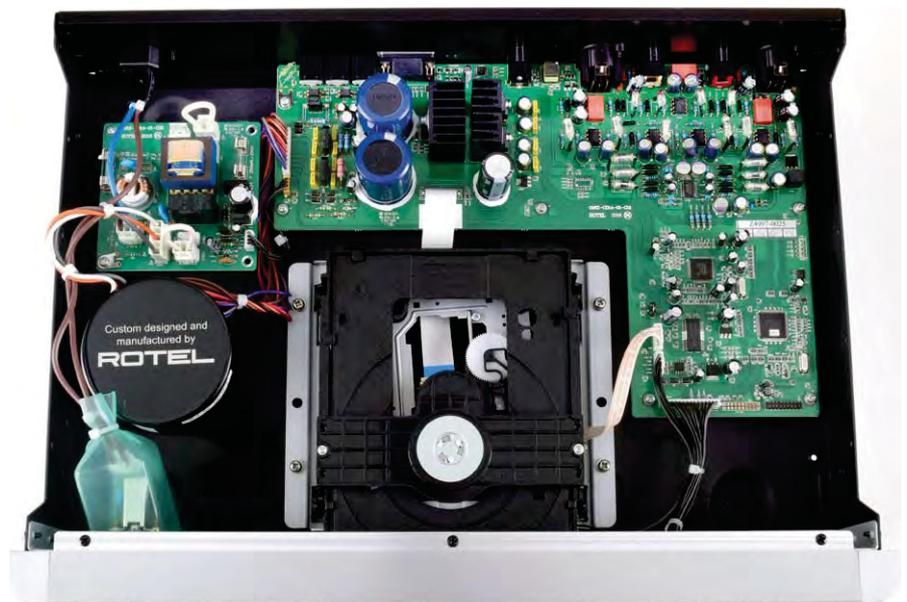
**KLASSISCH:** Rotel konzipiert seinen Player RCD-1572 als klassische Konstruktion mit mittiger Lade. Alle Bauteile werden für Rotel maßgefertigt, etwa der Ringkerntrafo links. Im Herzen der Digitalplatine: der D/A-Wandler WM8740 von Wolfson, der digitale Signale bis zu 24 Bit/192 kHz verarbeiten kann.
