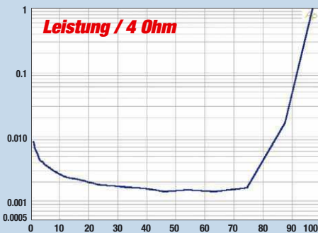
Der Verstärker punktet mit niedrigen Verzerrungswerten und einer sehr hohen Leistung von 192 Watt an vier Ohm je Kanal
