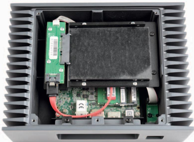
Der Nucleus+ basiert auf einem Intel NUC Core i7 und kommt ganz mit passiver Kühlung aus. Dazu ist das Gehäuse weitgehend in einem Stück als Voll-Aluguss mit Kühlrippen ausgeführt und wird im Betrieb recht warm. Durch den Einbau einer 2,5-Zoll-Festplatte lassen sich neben Metadaten auch Musikdaten speichern.
