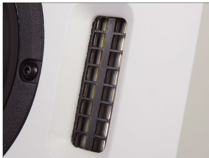
Der EMIT-Bändchen Hochtöner ist seitlich des Tief/Mittel-Töners angebracht. Diese Anordnung kommt fast so gut wie nie vor
