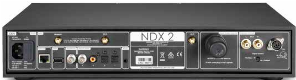
USB, Digi-Ins und zwei alternative Analogausgänge, darunter Naims superber DIN-Abgriff. Man beachte, dass der NDX2 mit drei Antennen auch für optimalen Funkverkehr vorbereitet wurde.
