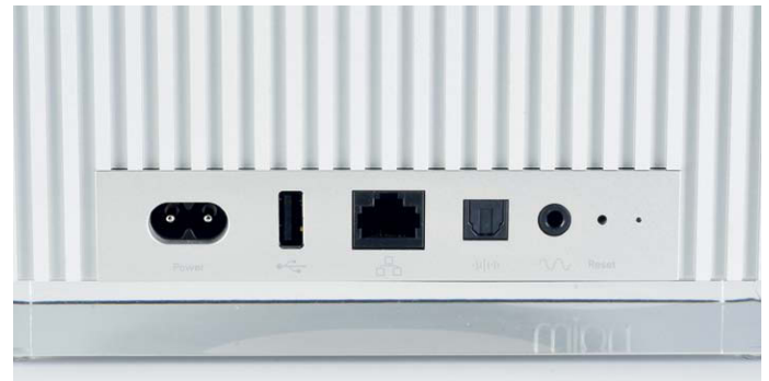
Über den LAN-Anschluss lassen sich WAV, FLAC und AIFF mit bis zu 24 bit/192 kHz sowie ALAC mit 96 kHz streamen. Über WLAN sind maximal 48 kHz möglich. Alternativ geht HiRes via USB oder S/PDIF.
