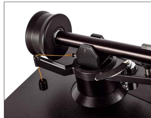
*Das Antiskating wird nach alter VäÙer Sitte mit Umlenkrolle, Faden und Gewicht realisiert*
