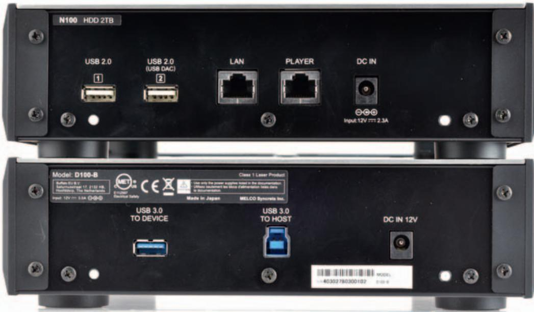
Über den separaten Player-Anschluss kommuniziert der Melco-Server N100 (oben) ohne Umwege direkt mit einem Netzwerkplayer, über den zweiten USB-Port kann er aber auch einen DAC ansteuern. Der andere USB-Port ist multifunktional und dient dem Anschluss von Zubehör wie dem Rip-Laufwerk D100 (unten).
