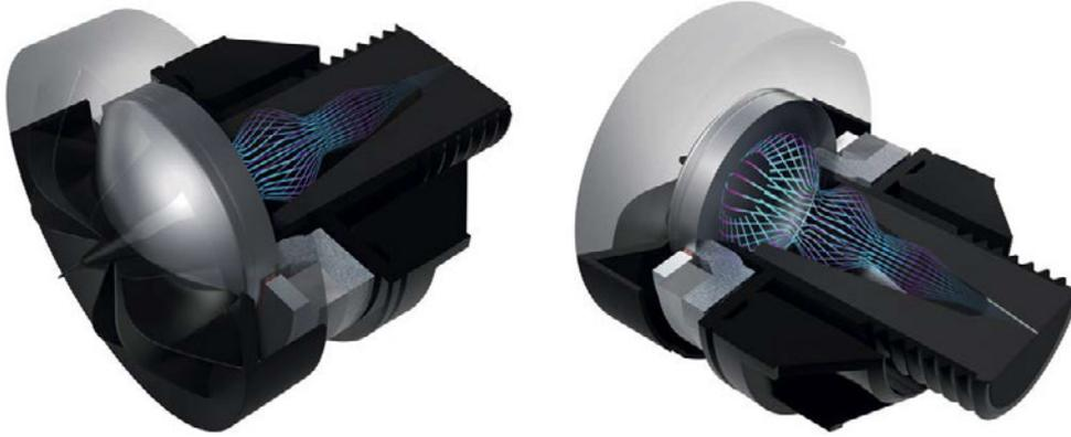
Der Unterschied liegt im Detail: Bislang befand sich hinter dem Hochtöner von KEFs Koaxialtreiber ein zylinderförmiges Volumen, in der 8. Generation der Q-Serie ist dieses Volumen nun kegelförmig. Das bedämpfte, nach hinten hin enger werdende Röhrrchen kann den von der Kalotte rückwärtig abgegebenen Schall besser kontrollieren, was vor allem die Wiedergabe im unteren Hochtonbereich verbessern soll.
