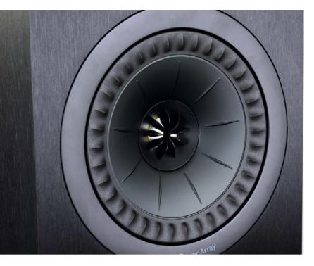
Der Uni-Q-Treiber ist seit Anbeginn das Markenzeichen der Q-Serie. In der Q750 deckt der Doppeltreiber mit einem Außendurchmesser von 16,5 cm den kompletten Frequenzbereich ab, der Übergang zur innenliegenden Hochtonkalotte liegt bei 2,5 kHz. Bei einer solchen Anordnung kommt der Schall über alle Frequenzen aus demselben Ursprung, Laufzeitunterschiede zwischen den Treibern werden damit minimiert.
