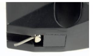
Die überaus feine Nadel des Hana SL ist im Aluminium-Nadelträger eingepresst, was Gewicht spart (Bild rechts). Das Anschlussfeld wurde farblich markiert: eine Erleichterung beim Anschluss. Da sich keine Gewinde im Systemkörper befinden, benötigen die Halteschrauben entsprechende Muttern.
