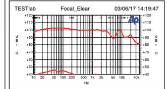
Insgesamt ausgewogen, aber mit einer markanten Senke bei 5 kHz, minimaler Klirr
