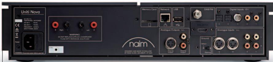
**INTEGRIERT:** Der Naim Uniti Nova zeigt rückwärtig seine Dreieinigkeit von Vollverstärker, Streamer und Digital-Analog-Wandler. HDMI- und BNC-Buchse zeugen von Anspruch.
