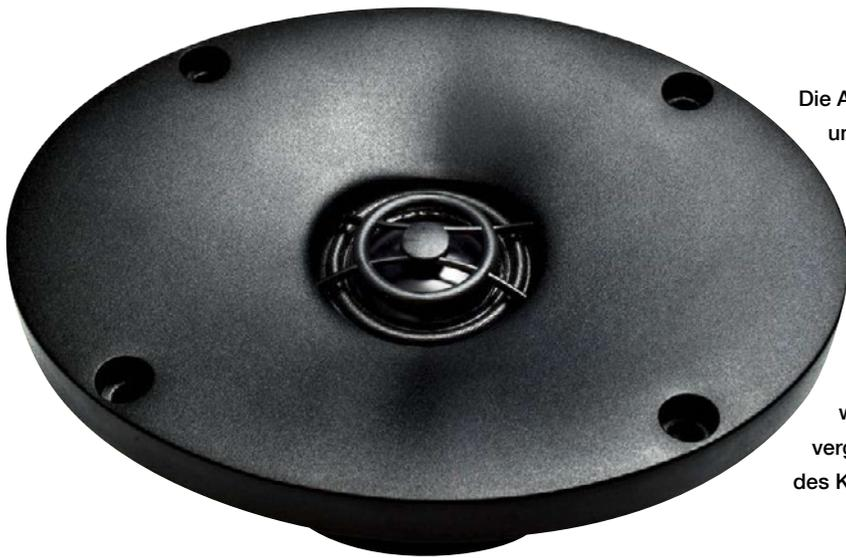
Die Alu-Kalotte ist vorne und hinten mit dem Kapton-Spulenträger verklebt. Die ungewöhnliche Formgebung des Waveguides harmonisiert nicht nur den Abstrahlwinkel, sondern vergrößert ihn dank des Knicks sogar.
