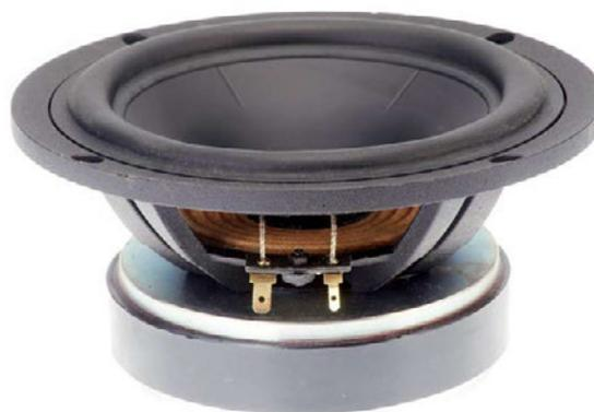
Obwohl der 5-Zöller (links) ein reiner Mitteltöner mit leichter Schwingenheit ist, sind Aufhängung, Korb und Magnet doch massig wie bei einem Bass gebaut. Die echten Tieftöner (rechts) sind mit größerer Spule ausgestattet, bei beiden erkennt man die beidseitig vulkanisierte Sicke und die geprägte Membran.
