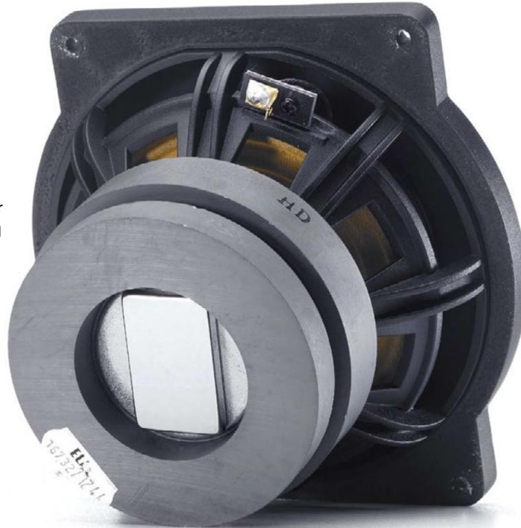
Der Aluminium-Gusskorb des nur 15 Zentimeter messenden Kristall-Konus ist ausgesprochen stabil ausgelegt. Die gelbe Zentrierspinne sitzt sehr weit vorne und erlaubt sowohl extrem große Hübe als auch eine problemlose Hinterlüftung, die Kompressionen und Überhitzung verhindert. Die beiden hinten aufgebrauchten Kompensationen homogenisieren das Magnetfeld des Ferrittrings.
