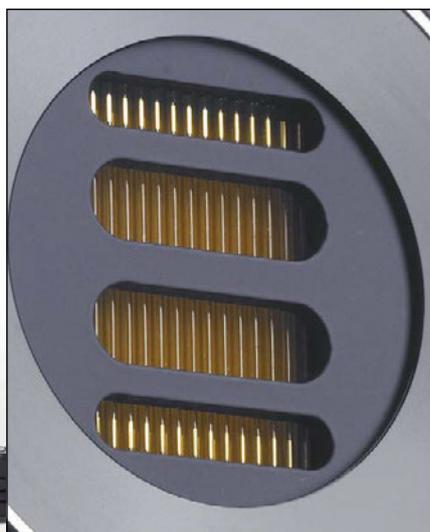
Hinter den schützenden Streben verbergen sich ultrastarke Neodym-Magneten. In dem Magnetfeld schwingt die zieharmonikaartig gefaltete JET-Membran, eine sehr leichte magnetostatische Folie mit aufgeklebten Leiterbahnen. Im Gegensatz zum klassischen Magnetostaten bietet sie eine um den Faktor 4 vergrößerte effektive Membranfläche bei identischer Abstrahlfläche.
