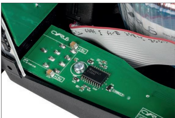
Der separate Kopfhörerverstärker arbeitet nach Class-AB-Prinzip
