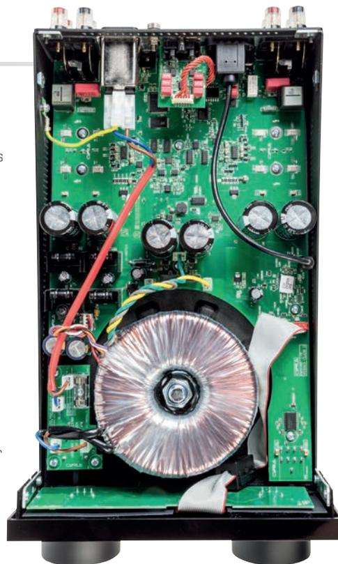
Ein überdimensionierter Ringkerntrafo liefert die Energie für die kräftigen Endstufen des One HD
