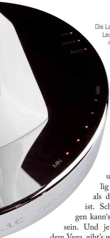
Die Lautstärke wird per Leuchtdioden angezeigt, im Hintergrund ist zu erkennen, welche Quelle gerade ausgewählt ist
