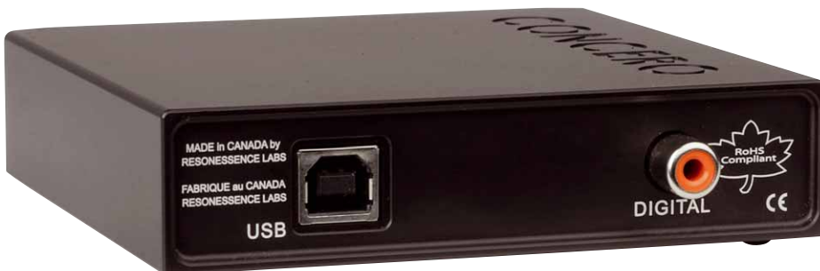
Die Koax-Buchse kann beide Richtungen. Sie ist sowohl als Signalein- als auch als -ausgang nutzbar. So ist der Concerro geeignet, den Computer in die Anlage zu integrieren
