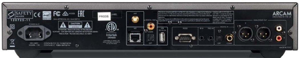
Die Anschlüsse verraten schon, dass der CDS50 mehr ist als nur ein SACD-Spieler. Er fungiert auch als D/A-Wandler und streamt Musik aus dem Netzwerk und von USB-Datenträgern.
