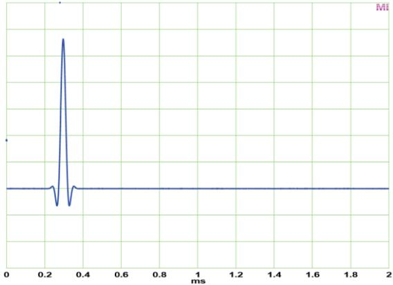
Die obigen Bilder zeigen das analoge Ausgangssignal der Filter des DAC, angeregt von einem digitalen Single Sample Impuls bei 44,1 kHz Samplefrequenz. Slow hat zwar die optimalste Antwort, verliert aber schon bei 15 kHz circa 1,2 dB, siehe Kapitel 31.4. Die beiden Short Delay sind IIR-Filter, die anderen beiden FIR. FIR ist phasenlinear über den Frequenzgang.
