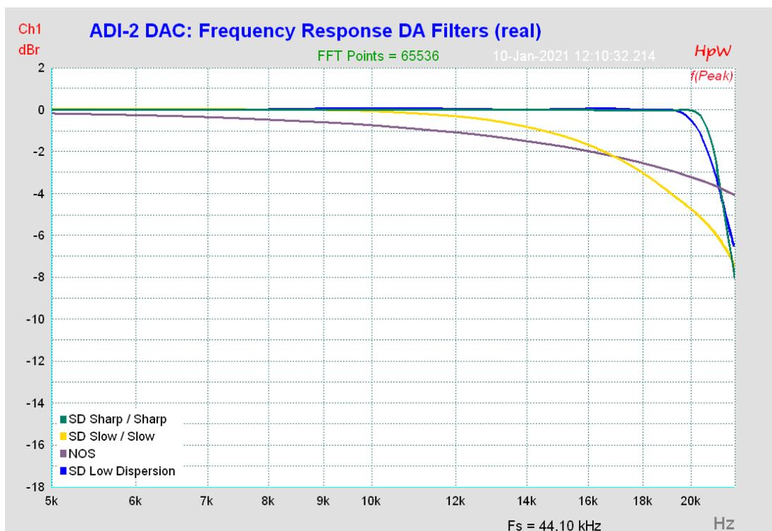
Hinweis: Sharp/SD Sharp und Slow/SD Slow sind deckungsgleich. NOS weist einen sehr frühen Abfall auf. SD Low Dispersion ist fast so linear wie Sharp/SD Sharp.
