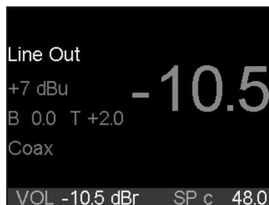
Um trotz fehlender Pegelanzeige eine Übersteuerung durch Volume, PEQ oder B/T erkennen zu können, ist die große Volume-Zahl mit der Over-Erkennung der analogen Ausgänge gekoppelt. Sie wechselt ihre Farbe bei Übersteuerung zu rot.
