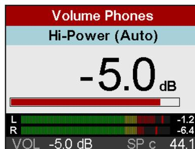
Nach korrekter Lautstärkeinstellung, mit der das Level Meter unterhalb des roten Bereichs bleibt, kann sich der Anwender nun 100% sicher sein, dass der ADI-2 DAC absolut verzerrungsfrei arbeitet, selbst in den extremsten Anwendungsfällen.
