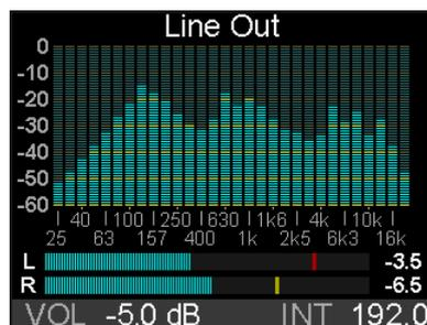
Analyzer und Level Meter zeigen DSD-Signale bei Green und Cyan in bläulicherer Farbe, die jeweilige Betriebsart ist daher sofort erkennbar (Amber wird etwas heller).
