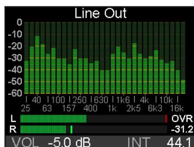
Anders als in den meisten anderen Lösungen wird keine FFT (Fast Fourier Transform) benutzt. RMEs Spectral Analyzer führt eine echte Bandpass-Filterberechnung durch, wie in professioneller Hardware. Der Frequenzabstand zwischen den Filtern entspricht dem menschlichen Hören. Hochoptimierter Code ermöglicht einen 30 Band Analyzer mit 60 dB Anzeigebereich, steilen Filtern und 1 dB Schritten pro Band auf dem DSP des ADI-2 DAC, selbst bei 768 kHz.
