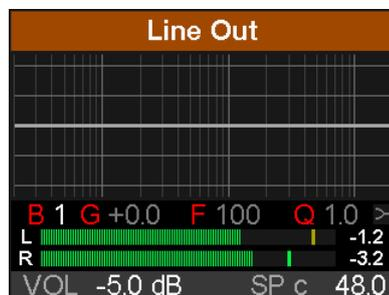
Die EQ-Grafik weist 5 Farben auf die den 5 konfigurierbaren Filtern entsprechen. Ist die Linie grau wurde der EQ deaktiviert (Bypass). Der EQ lässt sich im zweiten Bildschirm, der nach erneutem Druck der Taste EQ erscheint, aktivieren.
