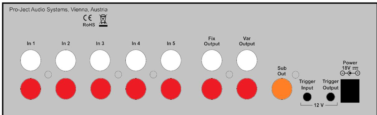
**Nehmen Sie Anschlüsse und das Trennen von Anschlüssen nur bei vom Netz getrenntem Gerät vor.**
