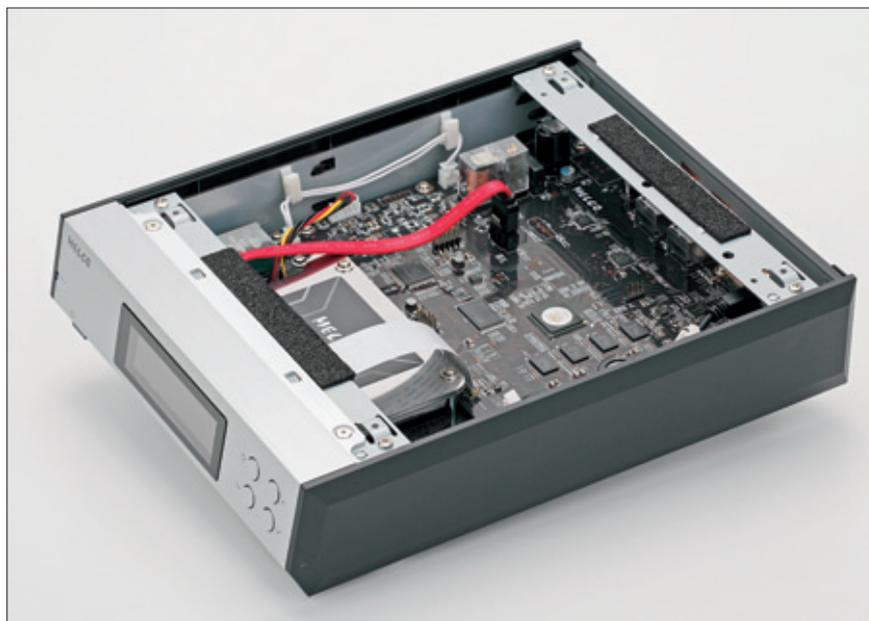
wie ein IT-Fremdkörper, der im HiFi-Rack nur geduldet wird. Als Stromversorgung dient ein externes Schaltnetzteil – einer der notwendigen Abstriche gegenüber dem deutlich teureren großen Bruder N10, welcher inklusive separatem Linear-Netzteil ausgeliefert wird.
