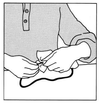
TREIBRIEMEN Der Treibriemen ist auf mindestens fünf Jahre regelmäßigen Betriebs ausgelegt. Der Treibriemen kann zur selben Zeit wie die Riemenscheibe gereinigt werden. Der Treibriemen kann gesäubert werden, indem Sie ihn durch ein feuchtes Tuch ziehen.
