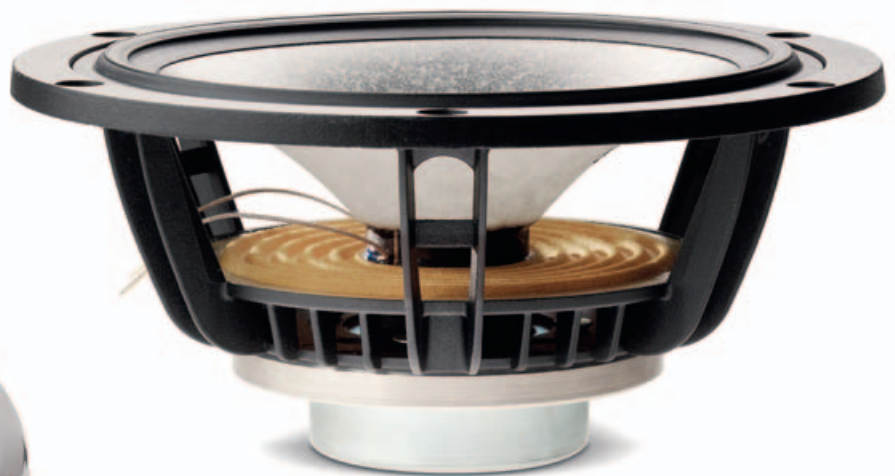
NEU VERMESSEN: Focal hat einen neuen Faraday-Ring entwickelt, der mehr Stabilität an den Antrieb bringen soll. Die Membran selbst besteht aus einem Rohacell-Kunststoff, eingelagert zwischen zwei Glasfaserschichten.
