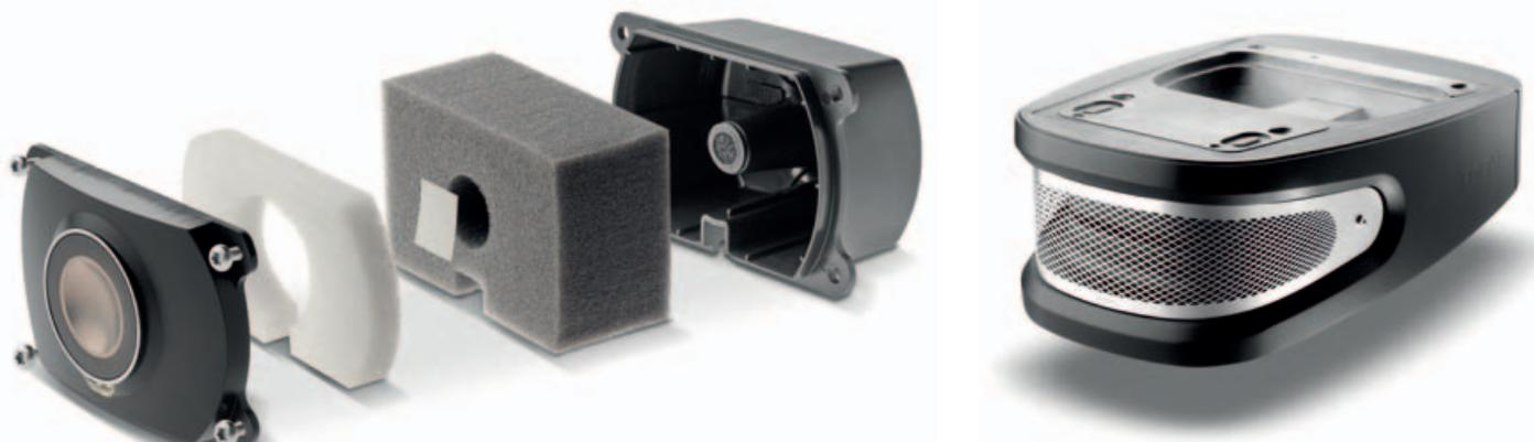
Durch eine Bohrung im Zentrum des Polkerns gelangen rückseitige Schallanteile der Inverskalotte aus Beryllium über eine kleine Kammer in ein Horn, das sie mit Dämmschaum unterschiedlicher Dichte bedämpft. Weil diese Lösung eine unendlich große Kammer simuliert, kommt es nicht zur Verdichtung der Luftmassen.
