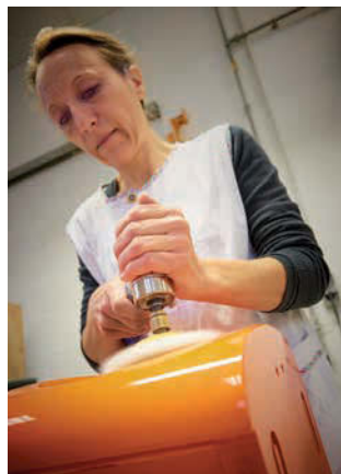
◀ Die Gehäuse der Focal-Serien Utopia, Sopra und Electra werden in Frankreich zusammengesetzt, geschliffen, lackiert und poliert. Zum Schluss erfolgt das Einsetzen der Treiber.
