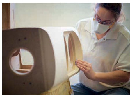
◀ Die Gehäuse der Focal-Serien Utopia, Sopra und Electra werden in Frankreich zusammengesetzt, geschliffen, lackiert und poliert. Zum Schluss erfolgt das Einsetzen der Treiber.
