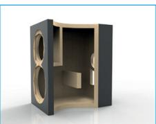
**Aus gutem Grund:** während die aufwändige Frequenzweiche für einen linearen Frequenzgang sorgt, helfen hohe Wandstärken des aus MDF gefertigten Gehäuses und die Verstrebungen unerwünschte Colorationen zu unterbinden. Der attraktive Look der Lautsprecher (Esche, schwarz) wird durch eine hochwertige, strukturierte Folierung gewährleistet.
