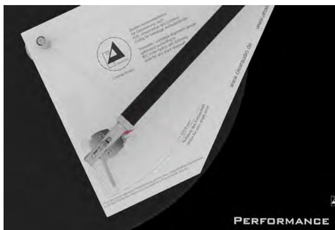
Abb. 11: Parallelität des Tonarmes
