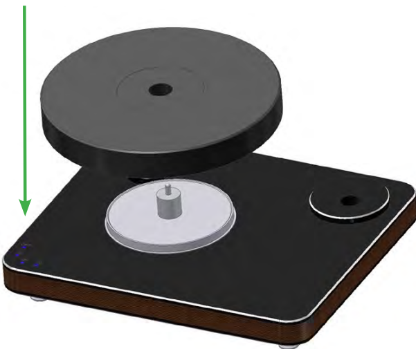
Abb. 8: Aufsetzen des Plattentellers auf das Lager
