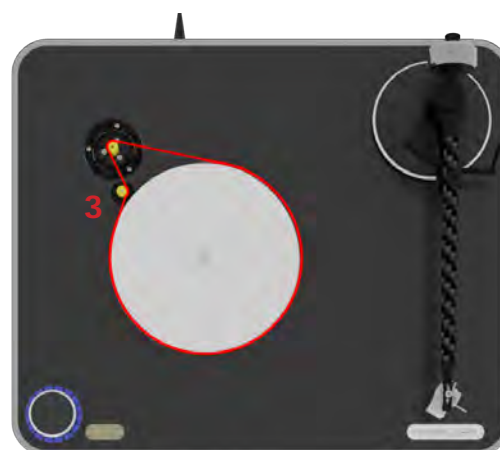
Abb. 3: Auflegen des Riemens
