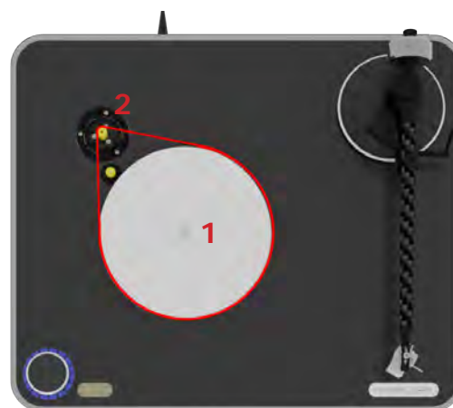
Abb. 2: Aufstellen des Laufwerkes
