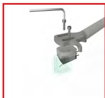
Abb. 8: Montage des Tonabnehmers
