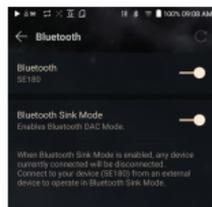
3. Die auf einem angeschlossenen Gerät abgespielte Musik wird über das SE180 ausgegeben.
