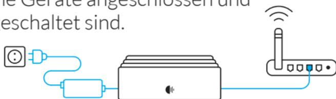
**Nucleus:** Verbinde die Stromversorgung mit Nucleus und stecke sie ein. Benutze ein Ethernet-Kabel, um Nucleus mit Deinem Router oder Switch zu verbinden.
