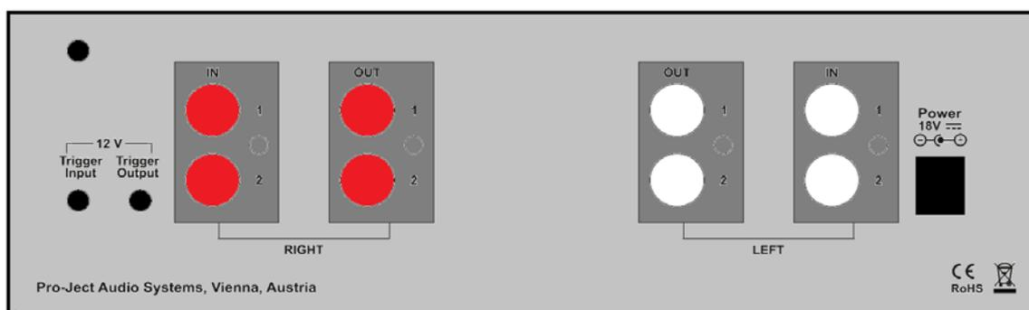
Nehmen Sie alle An- und Abschlüsse an den Phono-Vorverstärker ausschließlich **bei vom Netz getrenntem Gerät** vor. Verbinden Sie niemals die mit **Out** bezeichneten Buchsen mit dem Phono-Eingang eines Verstärkers.
