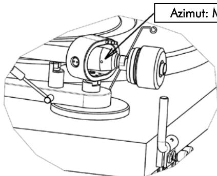
Lösen Sie die Madenschraube (Achtung: Nicht heraus drehen!) soweit, dass sich das Tonarmrohr (9) leicht um seine Längsachse drehen lässt. Mit Hilfe z.B. eines Geodreieckes lässt sich nun die Oberkante des Tonabnehmergehäuses parallel zur Schallplatte einstellen.
