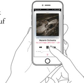
Halten Sie zum Koppeln mit anderen Bluetooth-Geräten die "Bluetooth"-Taste gedrückt, bis "Bluetooth Pairing" auf dem M-CR412 angezeigt wird.
