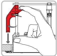
4.4 Ist der Rahmen angeschlossen, so kann er in die Deckenöffnung gehoben werden. Stellen Sie bei Lautsprechern mit einstellbarem Hochtöner in dieser Phase sicher, dass der Rahmen richtig ausgerichtet wird. Dazu muss der rote Pfeil auf dem Flansch des Rahmens in Richtung Hörbereich zeigen.
